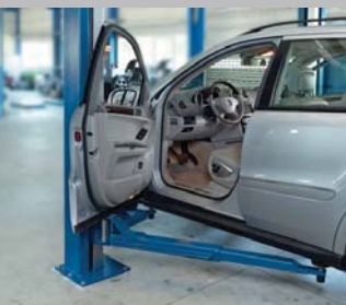
Optimale Tür-freiheit asymmetrische Tragarm-anordnung
