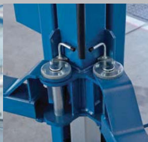
Automatische Tragarmretrierung mit feiner Verzahnung, manuelle Entriegelung möglich
